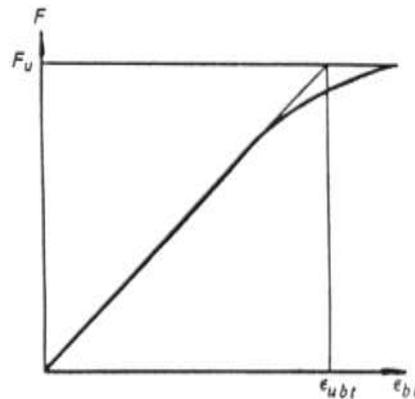
$F$  — нагрузка;  $F_u$  — разрушающая нагрузка;  $\varepsilon_{bt}$  — деформация растянутой поверхности образца;  $\varepsilon_{ubt}$  — предельная относительная деформация растяжения
