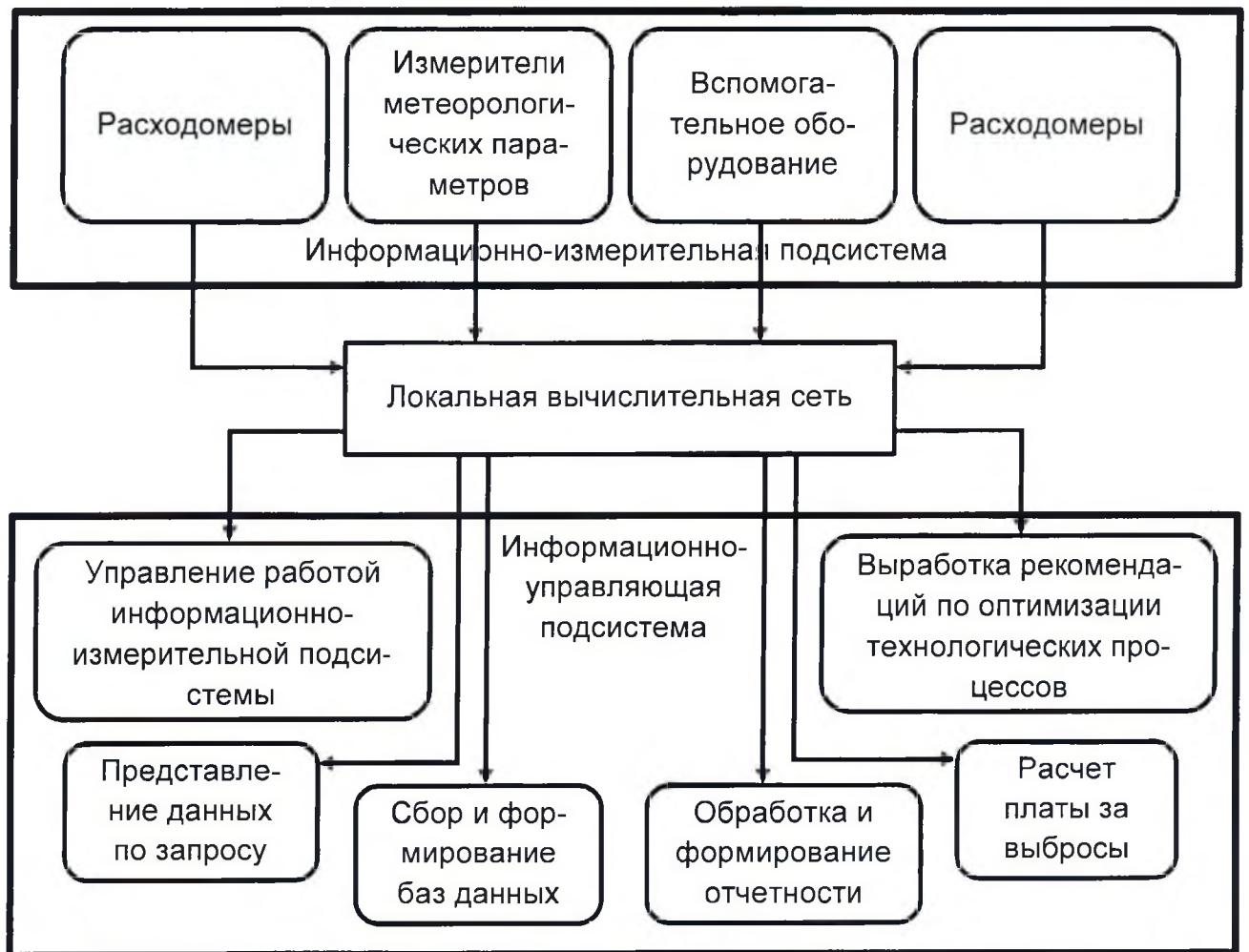
Рисунок 1 – Схема информационно-вычислительного комплекса АСНКиУВ
